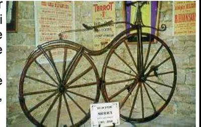
On cherche alors à rendre le vélocipède plus rapide. Comme les pédales étaient fixées de part et d'autre du moyeu de la roue avant, il fallait augmenter le diamètre de cette roue motrice pour accroître la distance parcourue à chaque coup de pédale. Alors le diamètre de la roue avant ne cessera d'augmenter tandis que celui de la roue arrière diminuait son rôle se limitant à permettre l'équilibre de l'ensemble.
