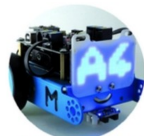
Afficheur LCD indique des informations lumineuses variables
